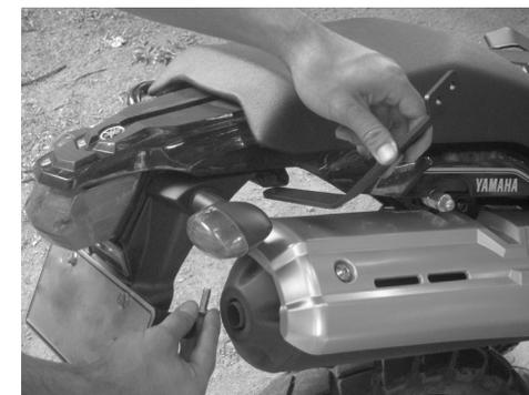
**3-** Soltar los tornillos que se encuentran en la parte lateral de la moto a la altura de las agarraderas del pasajero de la moto. Ubicar allí las platinas 6 y poner 2 bujes (F) a cada lado de la moto, de manera que los bujes queden entre la platina y la moto. Luego ajustar las platinas y los bujes haciendo uso de los tornillos suministrados (G).
