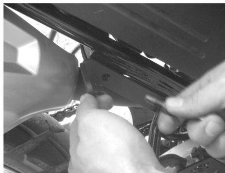
**1-** Soltar los posa pies de ambos lados de la moto y ubicar la platina 1 en el lado izquierdo y la platina 2 en el lado izquierdo. Ajustar ambas platinas haciendo uso de los tornillos suministrados (D). Luego poner la platina 3 anclándola de la platina 1 y la platina 4 anclándola de la platina 2. Ajustar ambas platinas haciendo uso de los tornillos suministrados (E) y las tuercas (B).
