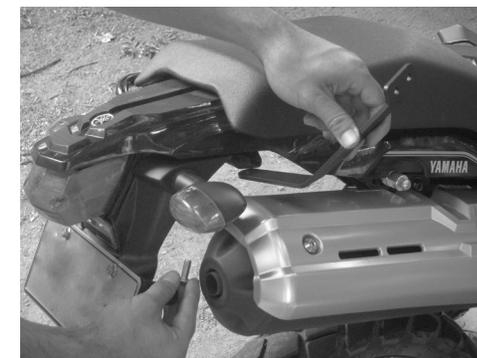
**3-** Luego en la perforación trasera que sujetaba las agarraderas, poner la platina 5 y asegurarla haciendo uso de los tornillos suministrados (E) y asegurarse de poner los bujes (F) de manera que queden entre la platina y la moto.
