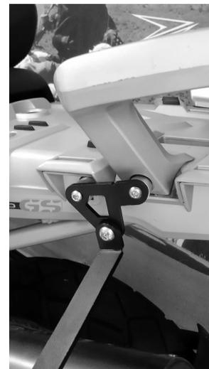
**3-** Ubicar el tornillo que se encuentra en la base de la agarradera del pasajero de la moto. Soltar dicho tornillo al igual que otro tornillo 6mm que se encuentra junto a este. En las perforaciones que resultan ubicar la platina 6. En la perforación frontal ubicar los bujes (G+H) y en la perforación trasera los bujes (H+I). Asegurar la platina haciendo uso de los tornillos suministrados (D).
