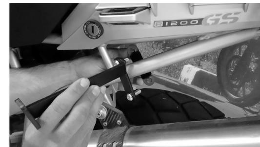
**1-** Ubicar el apoya pies del pasajero y en la platina que trasera de la misma pieza, ubicar las platinas 1,2 y 3, de manera que la platina 2 quede al interior de la pieza del apoya pies, la platina 1 en la parte exterior y la 3 en la parte posterior. Unir todas las platinas haciendo uso del tornillo suministrado (F) y una tuerca (B).
