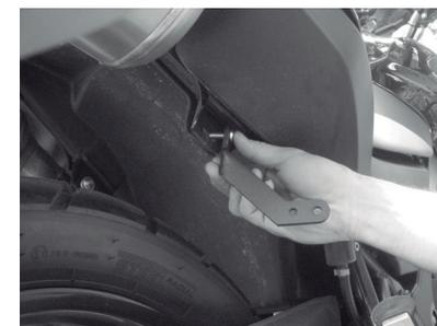
**4-** Ubicar los puntos de anclaje que se encuentran en la parte inferior de la moto, cerca de los mofles y allí poner las platinas 4 y asegurarlas haciendo uso de los tornillos suministrados (E) y las tuercas (B).
