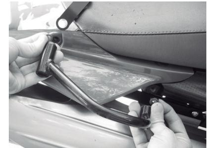
**5-** En la parte inferior de la agarradera ubicar el buje "F" entre esta y la moto para compensar el aumento en la parte superior. Ajustar el asa en la parte superior con el tornillo suministrado (E)
