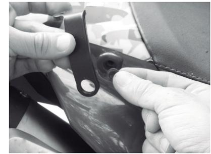
**4-** Soltar la agarradera de la moto para ubicar la platina "Agarradera" (3). Para esto se suelta la agarradera en ambos extremos y se procede a poner el buje "F" al interior de la perforación superior en la moto, de tal manera que este quede recostando entre la agarradera y la moto.
