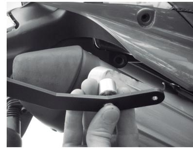
**1-** Soltar el mofle y en el anclaje del guardabarros (detrás del mofle) instalar la platina superior (2) con ayuda del tornillo suministrado (C) haciendo uso del buje (G) ubicándolo entre la moto y la platina.
