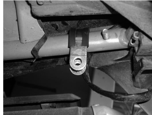
**3-** En la parte inferior de la moto, debajo de la silla ubicar un agujero en el chasis de la moto y allí poner un tornillo (A) de manera que la rosca salga. Luego un poco delante de este tornillo sujetar una de las abrazaderas (D).
