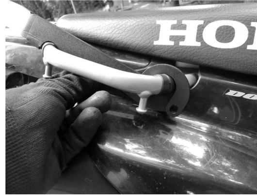
**1-** Pre ensamblar las platinas agarradera (3) y Enganche (2) y ponerlas en la parte frontal del asa, asegurándolas con el uso de los tornillos suministrados (A) y las tuercas (C).
