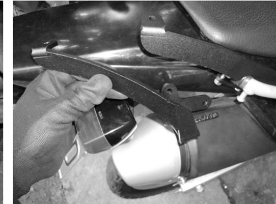
**4-** Luego Poner allí la platina Guarda barras (1) de tal manera que se sujete tanto del tornillo puesto en el chasis como se la agarradera sujeta al chasis de la moto. Una vez puesta y ubicada asegurar la platina haciendo uso de los tornillos suministrados (A) y las tuercas (C).
