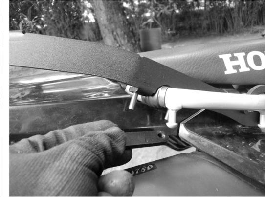
**2-** Ubicar la platina Agarraderas (3) en la parte posterior de las agarraderas de la moto, luego asegurarla con la platina Sujetador (4) haciendo uso de los tornillos suministrados (B) y las tuercas (C).
