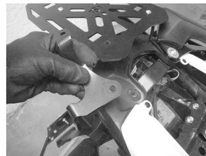
**2-** Soltar las agarraderas de la moto y ubicar en el agujero trasero un buje (I). Poner la platina Agarradera (2), luego otro buje (I) y proceder a poner la agarradera original de la moto, fijandola con el tornillo suministrado (C) y hacer uso de la arandela original de la moto.
