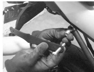
**1-** Soltar el tornillo original que sostiene la cercha (chasis) a la cola de la moto, poner la platina Cercha (3) asegurándose de poner el buje (H) de tal manera que quede entre la platina y la moto, asegurar la platina usando el tornillo suministrado (G).
