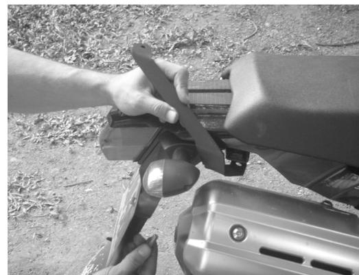
**2-** En las perforaciones traseras donde se ubicaban las agarraderas (parte inferior), poner la platina 3 y asegurarla haciendo uso de los tornillos originales que trae la moto para dichas perforaciones. Luego anclar las platinas 2 a la platina 3 previamente instalada haciendo uso de los tornillos suministrados (F) y las tuercas (G)
