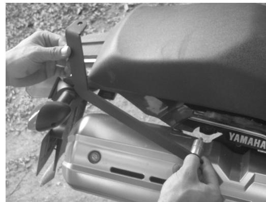
**1-** Soltar las agarraderas originales de la moto y retirarlas por completo. En la perforación frontal donde se ubicaban las agarraderas, poner la platina 1, asegurándose de poner un buje (D) y un buje (E) de tal manera que estos queden entre la platina y la moto. Asegurar estas piezas haciendo uso de los tornillos suministrados (B).
