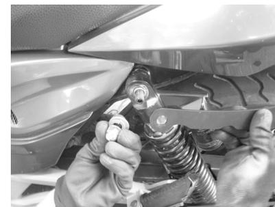
**2-** Soltar la tuerca que asegura el amortiguador y ubicar allí la "platina amortiguador" (4). Retirar una de las arandelas originales de la moto para crear espacio para la platina. Luego asegurar la platina haciendo uso de la tuerca original de la moto.
