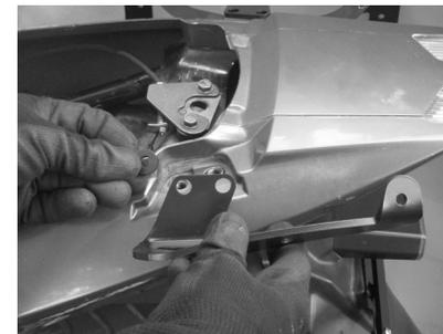
**1-** Soltar las agarraderas originales de la moto y remplazar por las "platinas agarraderas" (3). Instalarla asegurándose de poner antes los bujes (C) de tal manera que queden entre la platina y la moto. Luego asegurar las platinas haciendo uso de los tornillos originales.
