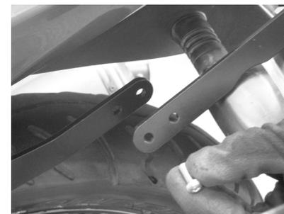
**3-** Anclar las platinas amortiguador (4) y Extensión (2) de las perforaciones de cada una, haciendo uso de los tornillos suministrados (A) y las tuercas (D).
