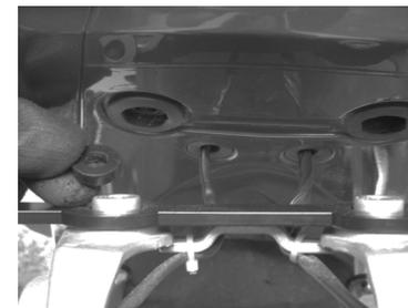
**4-** Soltar el soporte del porta placas en la parte inferior de la moto. ubicar allí la platina porta placas (4) asegurándose de poner los bujes (F) de tal manera que queden entre la moto y la platina. Luego asegurar haciendo uso de los tornillos suministrados (B).
