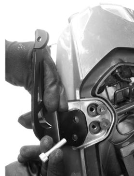
**1-** Soltar las agarraderas originales de la moto y reemplazar por las “platinas agarraderas” (3). Ponerla asegurándose de poner antes los bujes (G) y (F) de tal manera que queden entre la platina y la moto. Luego asegurar las platinas haciendo uso de los tornillos suministrados (A).
