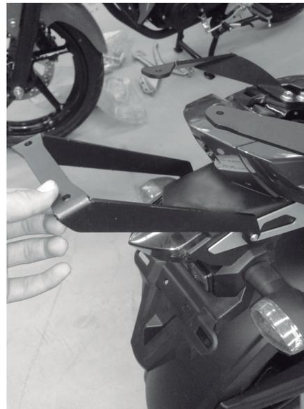
**2-** Retirar los tornillos que se encuentran en la cola de la moto, a los lados de la luz trasera de freno; poner allí la platina 3 y asegurarla haciendo uso de los tornillos suministrados (A) y los bujes (D) de tal manera que los bujes queden entre la moto y la platina 3.
