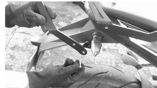
**3-** De la platina "guarda barro" (1) anclar las platinas "traseras" (4) haciendo uso de los tornillos suministrados (B) y las tuercas (C). luego de anclar estas platinas proceder a poner las platinas "extensión" (2) anclándolas de los agujeros ubicados en las platinas 3 y 4. Unirlas haciendo uso de los tornillos suministrados (B) y las tuercas (C).
