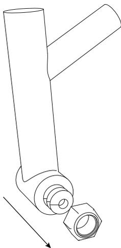
**1-** Retirar las tuercas y el perno original ubicado en la parte frontal del chasis de la moto.
