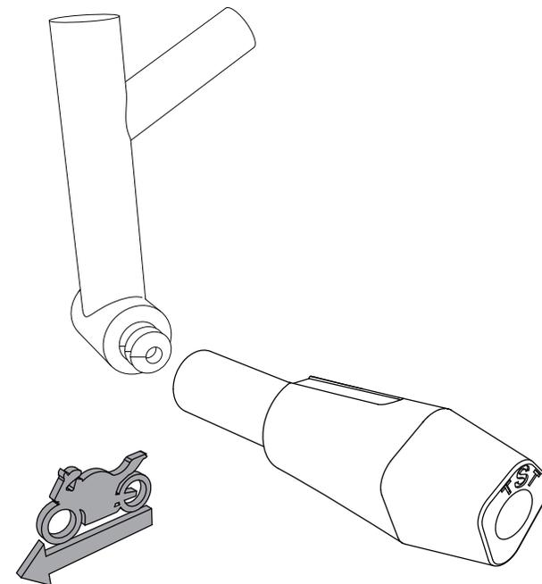
**3-** Ubicar a cada lado el buje suministrado (B) hasta ajustarlo con la mano. Poner el deslizador a cada lado haciendo uso de los tornillos (C) y comenzar a apretar hasta que el sistema quede totalmente fijo y sin vibracion alguna.
