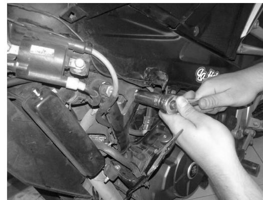
**3-** Retirar de la moto los tornillos de fábrica que van entre la platina y el motor como se ilustra en la imagen.
