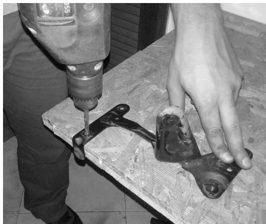
**2-** Separar los componentes hasta llegar a la platina indicada en la imagen (están ubicadas al lado derecho e izquierdo del motor), es necesario retirarlas para ampliar las perforaciones superiores con una broca de 9 mm.
