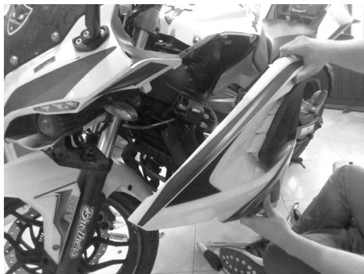
**1-** Retirar las tapas laterales de la moto. Se retiran con destornillador de estrella y llave hexagonal.
