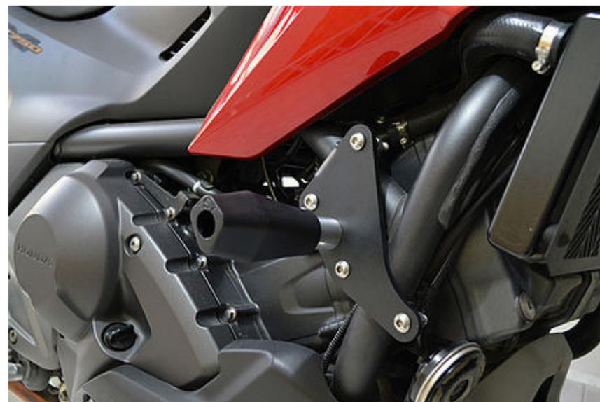
**1-** Ubicar el slider en el la parte lateral del chasis de la moto, en la unión que hay entre las dos tuberías cerca del motor. Deslizar las abrazaderas por detrás del tubo, deslizando la "abrazadera 1" por el tubo horizontal y la "abrazadera 2" por el tubo horizontal. Poner ambas abrazaderas de modo que los ojales queden apuntando hacia el exterior de la moto.
