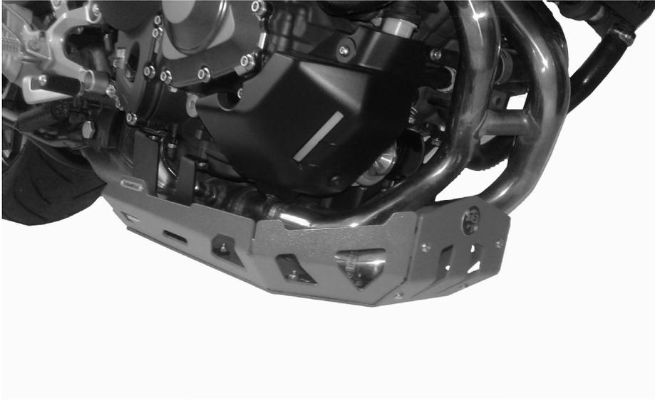
Antes iniciar con la instalación endurecer la suspensión lo máximo posible (herramienta viene con la moto), así aseguramos que lo moto con carga no baje tanto, mejorando el paso de obstáculos.
