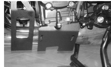
**2-** Tomar la platina 3 y ubicar en la parte inferior izquierda de la moto (cerca del sensor de la pata de apoyo lateral) los tornillos de los cuales irá anclada la platina. Soltar los tornillos y poner la platina haciendo uso de los tornillos originales de la motocicleta.
