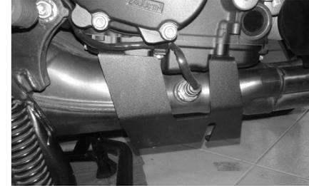
**1-** Tomar la platina 2 y ubicar en la parte inferior derecha de la moto (cerca del sensor del mofle) los tornillos de los cuales irá anclada la platina. Soltar los tornillos y poner la platina haciendo uso de los tornillos originales de la motocicleta.
