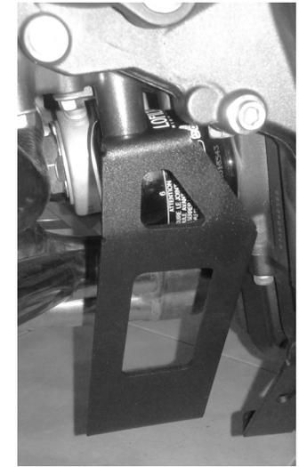
**3-** Tomar la platina 4 y ubicar el tornillo de anclaje (cerca del filtro de aceite, en la parte superior. Tornillo 8mm ubicado en sentido vertical, parte frontal). Retirar el tornillo original de la moto y poner la platina 4 haciendo uso de este. Asegurarse de poner la arandela de cobre (D), de manera que quede entre la platina y la motocicleta.
