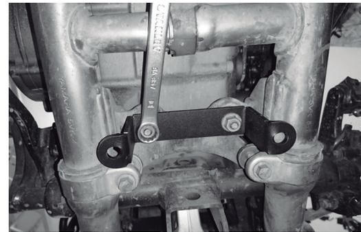
**2-** En la parte inferior de la moto ubicar dos tornillos de 8 milímetros que se encuentran cerca del gato lateral de la moto, por debajo de la misma. De estos tornillos anclar el “soporte B” (3) haciendo uso de la tornillería original de la moto.
