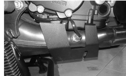
**1-** Tomar la platina 2 y ubicar en la parte inferior derecha de la moto (cerca del sensor del mofle) los tornillos de los cuales iría anclada la platina. Soltar los tornillos y poner la platina haciendo uso de los tornillos originales de la motocicleta.
