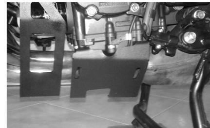
**2-** Tomar la platina 3 y ubicar en la parte inferior izquierda de la moto (cerca del sensor de la pata de apoyo lateral) los tornillos de los cuales iría anclada la platina. Soltar los tornillos y poner la platina haciendo uso de los tornillos originales de la motocicleta.
