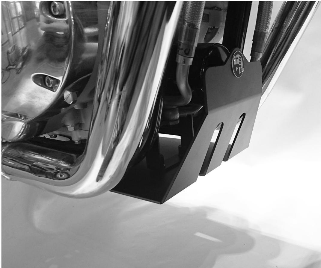
**1-** Retirar los tornillos que se unen el chasis al motor en la parte frontal inferior, cerca del filtro de aceite. Anclar allí la pieza #2 haciendo uso de los tornillos y tuercas originales.
