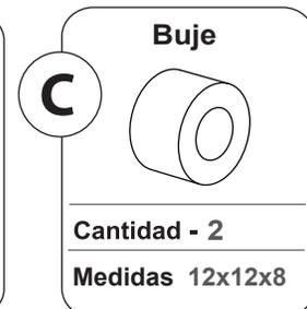
**1-** Soltar los tornillos originales que sostienen el TPS de la moto. En las perforaciones resultantes ubicar el protector de TPS, poniendo los bujes (C) de manera que queden entre la moto y el protector. Asegurar haciendo uso de los tornillos suministrados (B).
