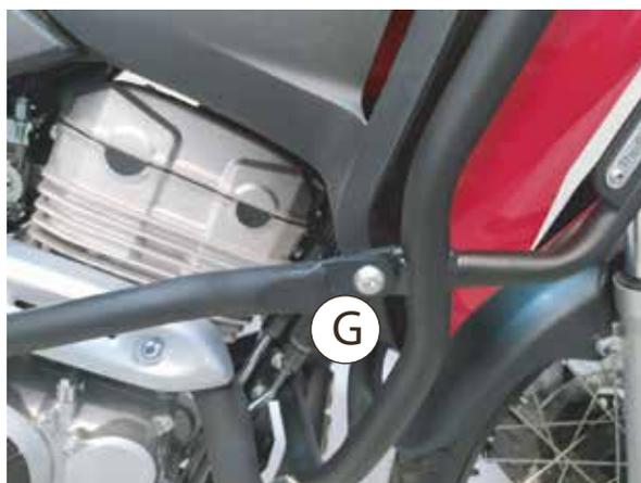
Imagen #4 - Instalación extensión 3 a defensa 1 usando tornillo G, arandela H y tuerca se desigualdad E
