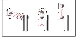
Los anclajes del extensor de cúpula poseen un gran rango de movimiento, por lo que pueden adquirir diferentes posiciones dependiendo de las necesidades del usuario.
