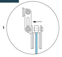
Al poner el extensor de cúpula, ubicarlo en el lugar deseado y luego ajustarlo a la cúpula original apretando únicamente un tornillo con la herramienta adecuada.
