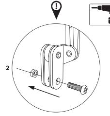
Se sugiere la posibilidad de perforar el visor original de la moto para lograr un mayor ajuste del extensor de visor TST. Perforar con la herramienta adecuada y con el mayor cuidado posible para evitar daños. Asegurar la pieza con la tornillería suministrada.
