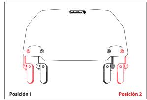
Los anclajes se pueden ubicar en las diferentes posiciones (perforaciones) del extensor, dependiendo del ancho de la cúpula a la cual se va a anclar.
