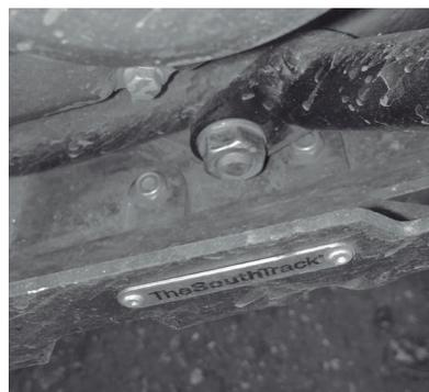
**3-** Retirar el tornillo original ubicado en la parte inferior del motor.
