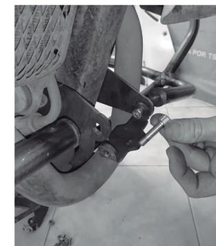
**4-** Poner el anclaje central (3) entre la defensa izquierda y la derecha como se muestra en la imagen. Asegurar con tornillos (C).
