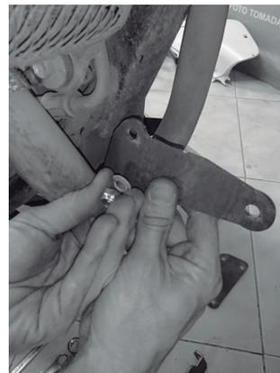
**1-** Retirar los dos tornillos ubicados en la parte frontal de la moto cerca al motor y el chasis.
