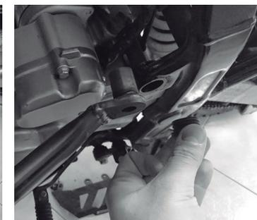
**2-** Retirar el tornillo ubicado en la parte Trasera del motor y el tapón del lado izquierdo
