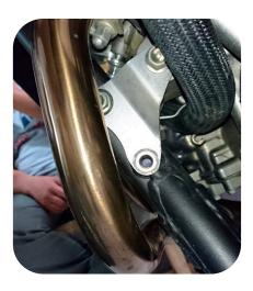
**2-** Retirar el tornillo pasante infeior ubicado en la platina que sostiene el motor.
