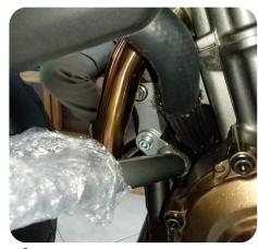
**4-** Unir la parte inferior de la defensa con el tornillo (C) y fijar con la tuerca (E), asegurandose de poner entre la cabeza del tornillo la arandela (E) y entre la tuerca y la platina la arandela (E)
