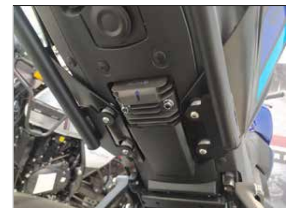
Imagen # 5 - Detalle sujeción inferior cola.
