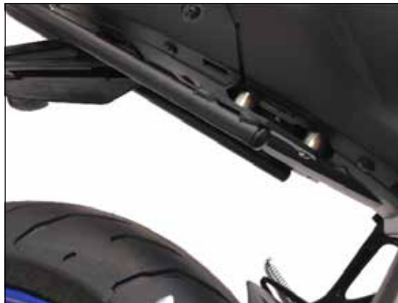
Imagen # 4 - Sujeción soportes G. a bujes H. usando tornillos I. a parte inferior de la cola del vehículo.
