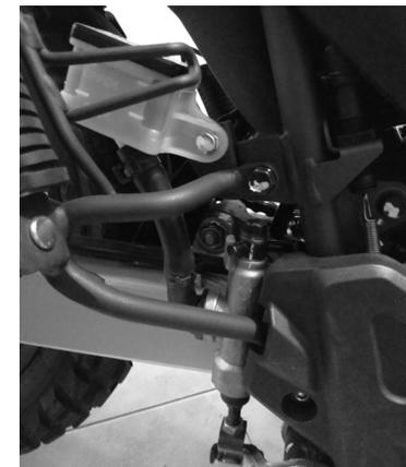
**2-** Soltar los tornillos originales que se encuentran en la cola de la moto. Poner allí las platinas 3 y los bujes (H) de manera que el buje quede entre la platina y la moto. Asegurar haciendo uso de los tornillos originales. Una vez puesta esta pieza, anclar la platina 4, haciendo uso de los tornillos (B) y las tuercas (F).
