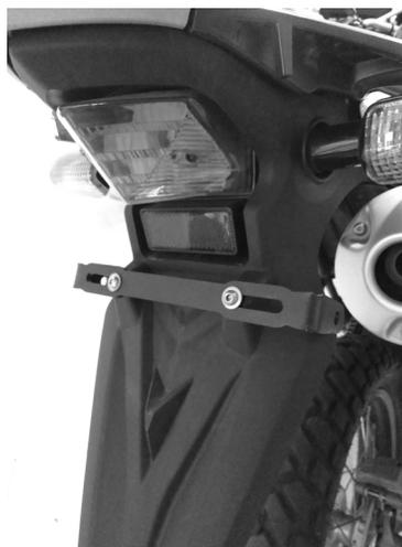
**3-** Ubicar los tornillos que sostienen los posa pies del pasajero de la moto y soltar el tornillos superior de estos (en ambos lados). Ubicar allí la platina 5 y los bujes (G) de manera que el buje quede entre la latina y la moto. Asegurar haciendo uso de los tornillos suministrados (C).
