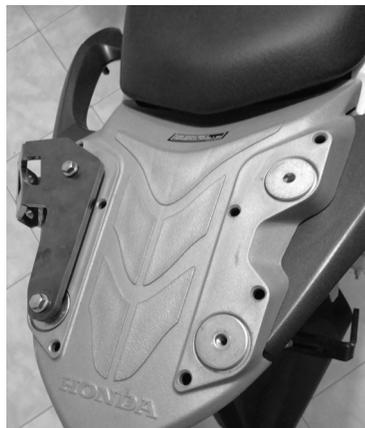
**1-** Ubicar los tornillos que sostienen la placa (matrícula) de la moto y ubicar allí la platina 1 haciendo uso de los tornillos (A), las arandelas (D) y las tuercas (E). Una vez puesta esta pieza, anclar la platina 2, haciendo uso de los tornillos (B) y las tuercas (F).
