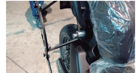
**3-** Retirar el tornillo ubicado en la parte delantera en el punto de sujeción de la agarradera del pasajero. Poner allí la platina corta (4) haciendo uso de un buje (G) y un buje (H), asegurar haciendo uso de (D).
