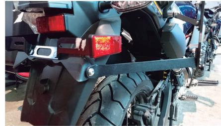
**1-** Retirar la placa y el porta placa original de la moto. Poner la platina placa (1) entre el porta placa y el babero de la moto; asegurarlo con los tornillos y tuercas originales de la moto. De un extremo de la platina placa poner con un tornillo (B) la platina (2) y asegurarla con la tuerca (E).
