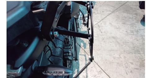
**4-** Retirar el tornillo ubicado en la parte trasera en el punto de sujeción de la asa. Poner allí la platina larga (3) haciendo uso de un buje (G), asegurar haciendo uso de (D).
