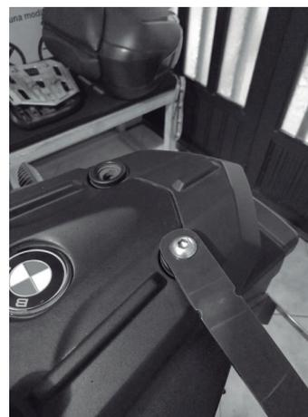
**4-** Retirar la placa (matrícula) de la moto y en su lugar ubicar la platina 1 haciendo uso de los tornillos (A) y las tuercas (E). Una vez puesta esta pieza, unirla con la platina 2 haciendo uso de un tornillo (B) y la tuerca (F).
