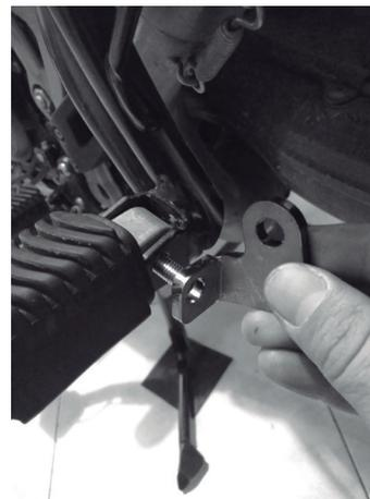
**1-** Ubicar el pasador (pin) que sostiene el posapiés del pasajero de la moto y retirarlo. En la parte posterior del posapiés ubicar la platina 6 y asegurarla haciendo uso del tornillo (D) y la tuerca (F). Una vez puesta esta platina, anclar allí la platina 7 haciendo uso del tornillo (B) y la tuerca (F).
