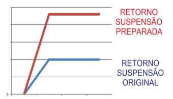
**OBS:** após a preparação da suspensão dianteira o retorno passa a atuar mais lento, conforme demonstra o gráfico acima.
