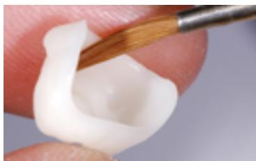
Recouvrir l'intrados de la restauration en céramique avec IPS Natural Die Material Separator et laisser agir quelques instants.
