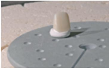
Une fois le programme de cristallisation terminé, sortir le support de cuisson du four et laisser refroidir la restauration IPS e.max CAD à température ambiante.
