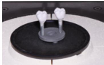
Placer le support de cuisson IPS e.max CAD Speed Crystallization Tray (maximum de deux restaurations IPS e.max CAD HT/MT/LT) dans le four et cuire selon les paramètres de la cuisson de cristallisation Speed.
