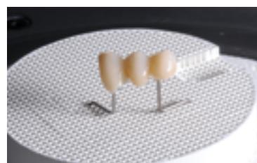
La couche de connexion doit être cuite avant de commencer la stratification. Placer le support de cuisson nid d'abeille dans le four et procéder à la cuisson de connexion en respectant les paramètres de cuisson indiqués.
