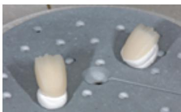
Une fois le programme de cristallisation terminé, sortir le support de cuisson du four et laisser refroidir la restauration IPS e.max CAD à température ambiante.
