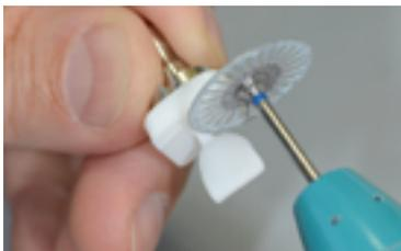
Séparer soigneusement la facette pelliculaire du bloc à l'aide d'un disque à séparer diamanté.
