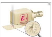
III. 1 : test Vickers de la céramique silicatée : les fissures se poursuivent du fait de la fragilité du matériau.
