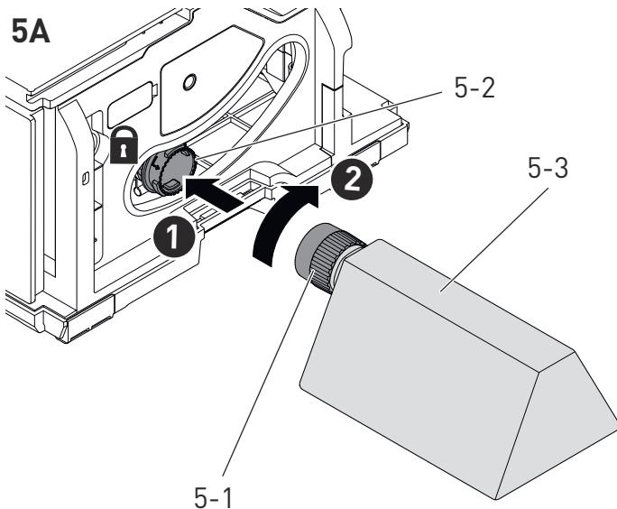
Les bourrages dans le capot de protection risquent d'altérer les fonctions de sécurité. Pour éviter les bourrages, nous conseillons de travailler avec un aspirateur fonctionnant avec la pleine puissance d'aspiration.
