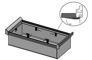
**STEP 1:** INSERT THE CLIPS INTO THE CHANNEL UNDER THE FRONT AND REAR CROSS BARS. THE CLIPS CAN BE PLACED ANYWHERE ALONG THE CHANNEL.
