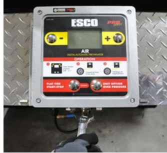
Step 2. Remove 1/4" outlet plug.
