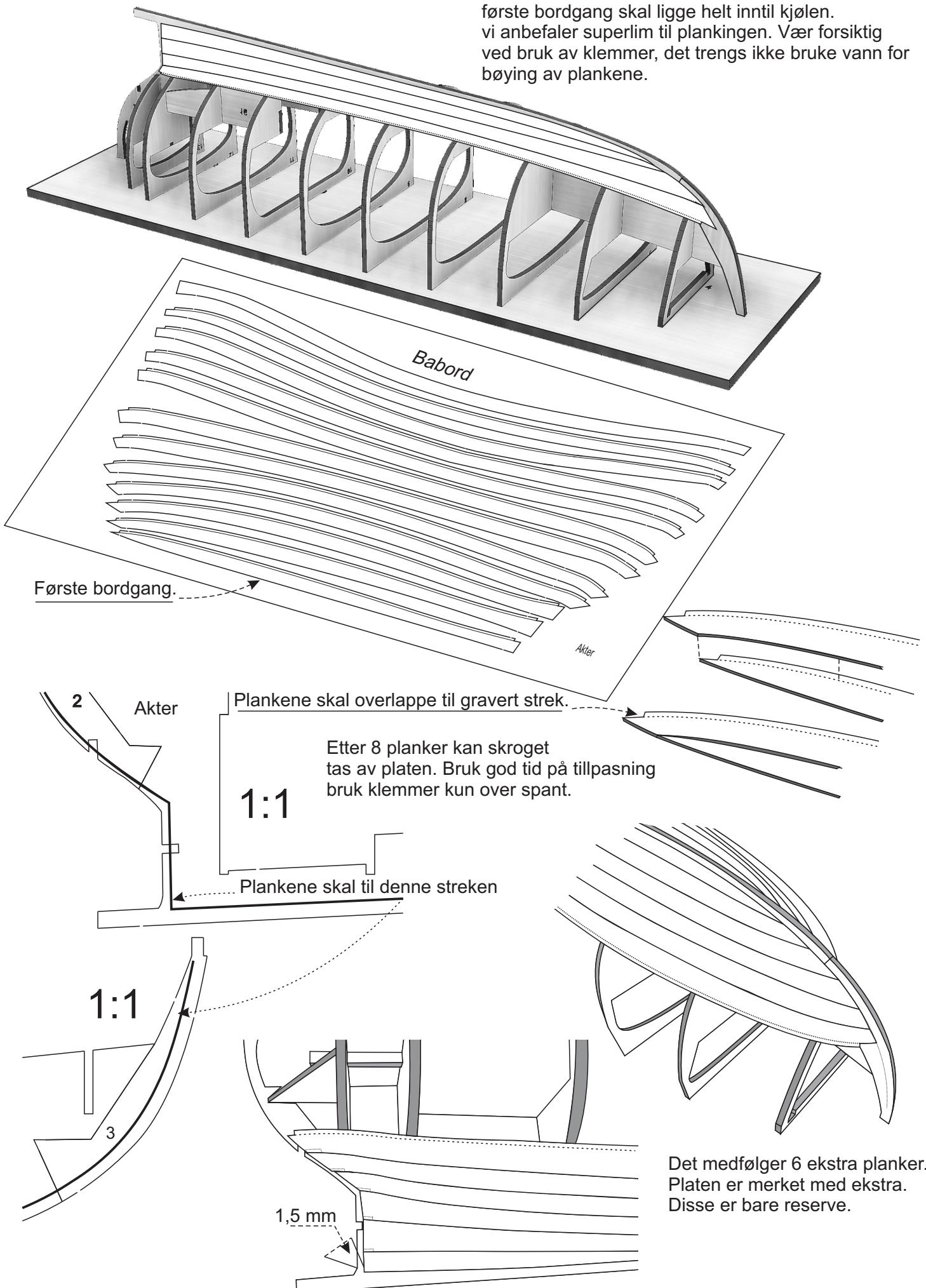
Skjær av spantene helt ned til bordgangen
