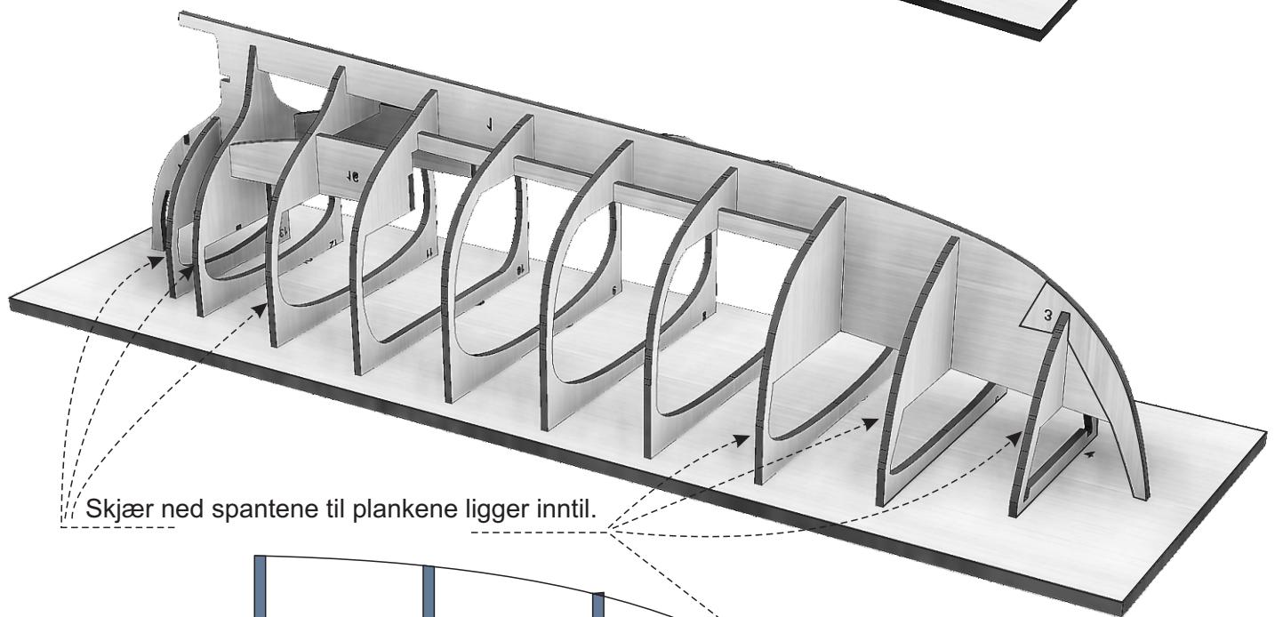
Skjær ned spantene til plankene ligger inntil.
