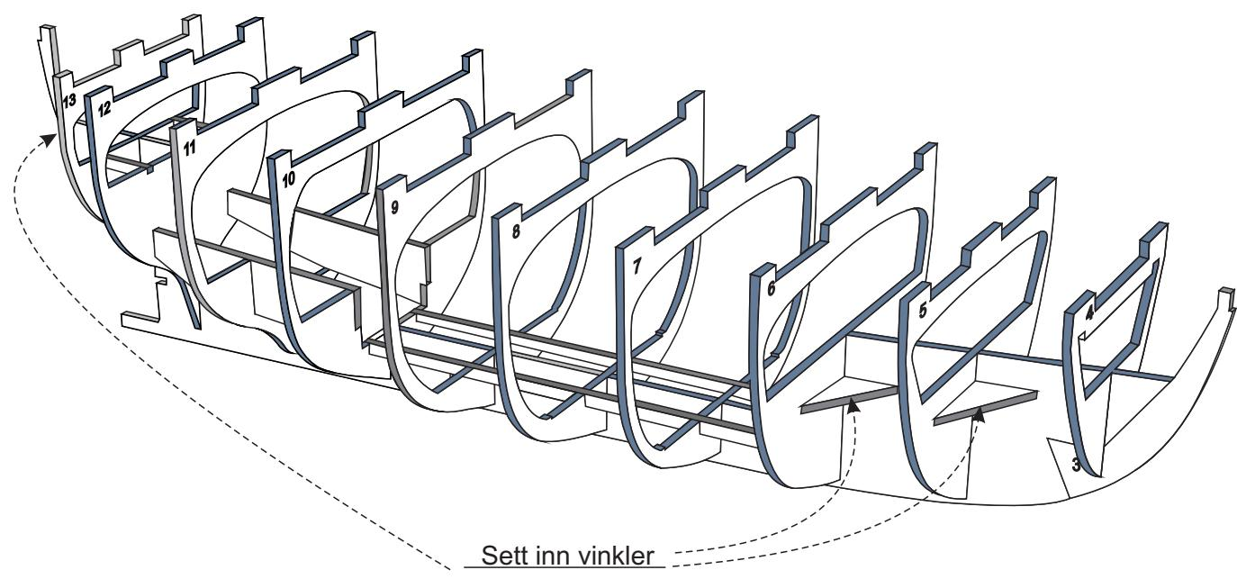
Spantene trenger ikke limes på platen.
