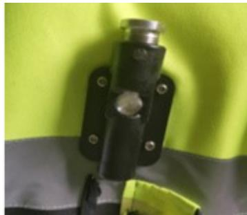
Étape 3 : Retirer le capuchon de protection. Desserrer l'écrou de serrage et régler le piston à l'aide d'un tournevis ou d'un outil similaire de manière à ce que l'évidement du piston soit aligné avec l'emplacement de la douille de verrouillage au centre du boîtier de libération.
