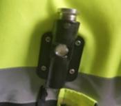
Etape 3 : Retirer le capuchon de protection. Desserrer l'écrou de serrage et régler le piston à l'aide d'un tournevis ou d'un outil similaire de manière à ce que l'évidement du piston soit aligné avec l'emplacement de la douille de verrouillage au centre du boîtier de libération.
