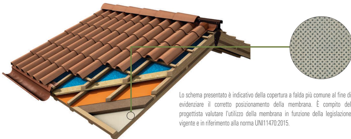
Lo schema presentato è indicativo della copertura a falda più comune al fine di evidenziare il corretto posizionamento della membrana. È compito del progettista valutare l'utilizzo della membrana in funzione della legislazione vigente e in riferimento alla norma UNI11470:2015.
