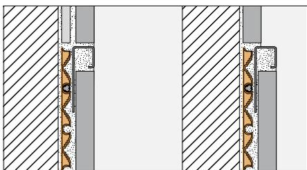
Esempio di posa: zona scaldata contraddistinta visivamente tramite Schlüter®-QUADEC
