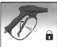
¡ATENCIÓN! Al detener el equipo, es importante accionar nuevamente el bloqueo de seguridad ubicado en la pistola para evitar accidentes.
