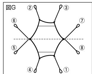
※ロープの引き過ぎにご注意ください。強く引きすぎている場合は、その方向に大きなしわが発生します。しわの出ているコーナーのサブロープを緩めて、全体のテンションバランスを調整してください。[図H]
