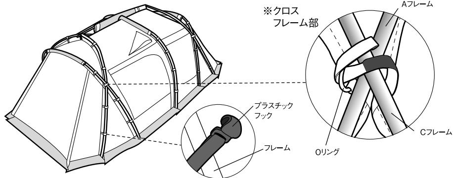
⑦裾部リングピンに付いている、ベグダウン用ループ及びテープにジュラビンベグを通して、全て室内側でベグダウンします。また、付属の張り網ロープも、しっかりとベグダウンします。出入口用ドアパネルを張り出す場合は別売のアップライトポール(TP-080)を使い二又のロープで立ち上げてください。シワが残らない様にロープの方向を調整してください。
