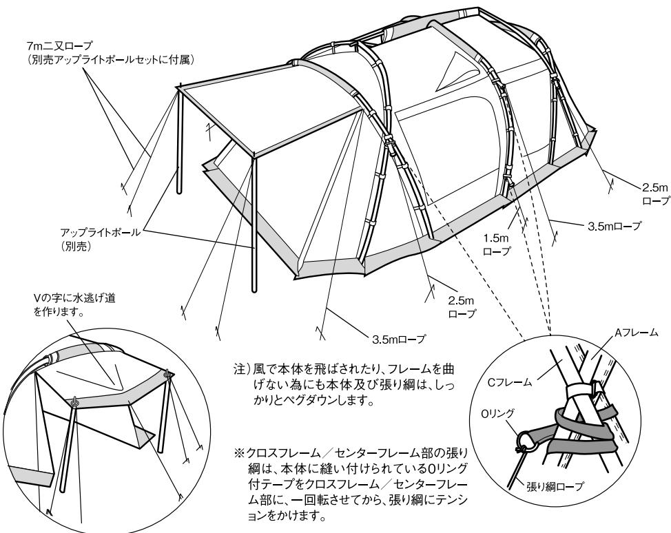
⑥必要に応じて最後にビルディングテープのバックルをはずし、テープをポケットに収納してください。(設営後にビルディングテープを外す場合は、必ず室内側にペグダウンをしてテンションを室内側にかけてください。)
