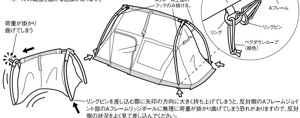
④黒色の印がついたCフレームを少しづつ繰ぎ黒色のテープがついたスリーブに通していきます。次に③同様にリングピン(黒紐付き)を差し込みます。片側のCフレームを立てた後もう一方のCフレームも同様に立ち上げます。
