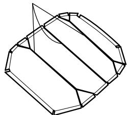
②最初に、紺色の印がついたAフレームリッジポールを真中の紺色テープのスリープに入れます。そしてAフレームジョイント部についている2個の紺色シールが外側に向く様にリッジポールを差し込みます。リッジポールの端がAフレームジョイント部の最後までしっかりと入った事を確認し、センター・リングを奥まで押し込む様に入れて引っ掛けます。(図A)
