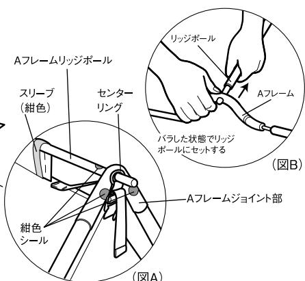
③本体の裾部にある紺色紐が付いたリングピンを持ちAフレームに差し込みます。(4ヶ所)
