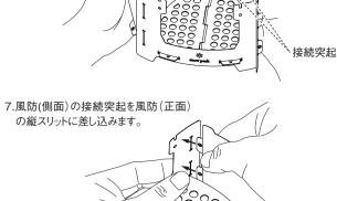
6.風防(側面)の接続突起を風防(側面)の縦スリットに差し込みます。
