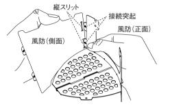
5.3と同様の手順で二つ目の風防(側面)を取りつけます。 ①【突起が凹んでいる面】が外側になるよう確認してください ②風防(側面)の横スリットが下になるように上下の向きを確認してください。 ③ボトムプレート側面の突起を、風防(側面)の横スリットに差し込みます。
