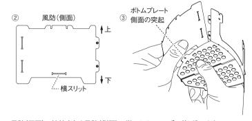
4.風防(正面)の接続突起を風防(側面)の縦スリットに1つずつ差し込みます。
