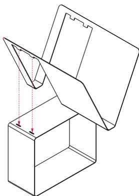
Fissare il basamento negli appositi fori sulla fascia di supporto.
