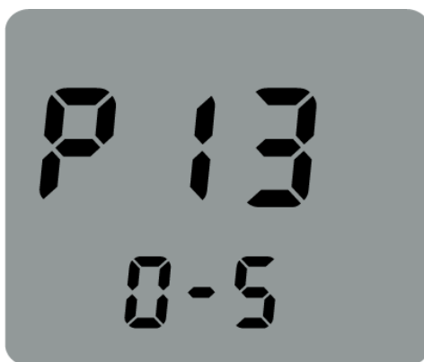
Interface de réglage de niveau PAS
