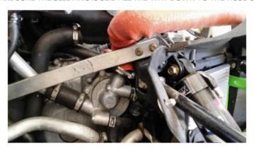
14. NOTCH THE TOP OF THE SUPPORT FRAME TO PROVIDE CLEARANCE FOR THE HARD LINE AROUND THE TURBO/EXHAUST. MAKE SURE TO DEBUR THE NOTCH. SEE PICTURE BELOW
