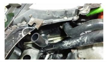
INSTALL FIRESLEEVE ON THE LONG HOSE. YOU MAY HAVE TO INCH IT ON TO GET THE FIRESLEEVE TO SLIDE PAST THE BENDS. THE FIRESLEEVE INSTALLATION SHOULD LOOK LIKE THE PICTURE ON THE NEXT PAGE WHEN COMPLETED.
