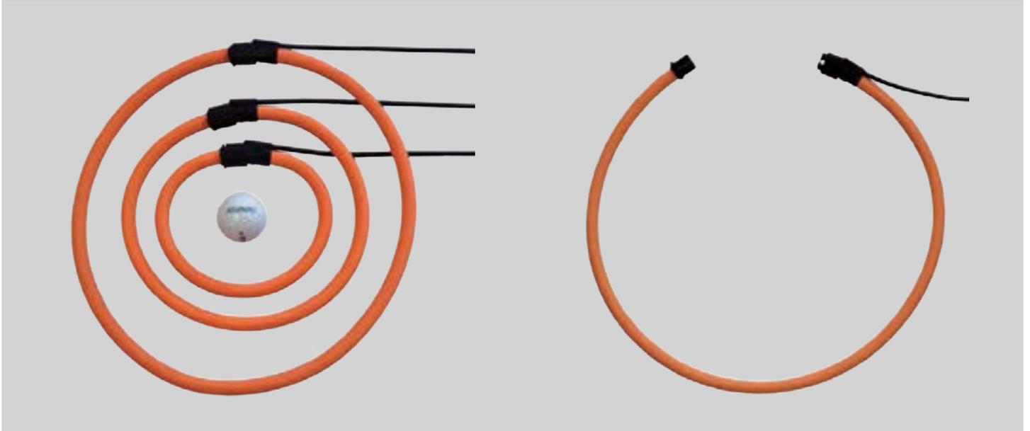
La flexible Bobina de Rogowski ofrecida por Accuenergy está diseñada para ser utilizada en lugares donde los transformadores convencionales o de núcleo partido no pueden ser usados. Es ideal para monitorear calidad de potencia como ser las armónicas. Las ventajas de esta alternativa incluyen alta precisión, amplias mediciones y rango de frecuencias sin necesidad de un integrador externo o de una fuente externa de alimentación.
