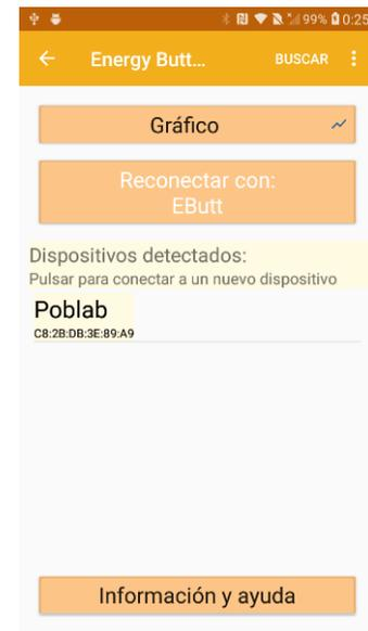
Después de seleccionar el dispositivo al que se quiere conectar, durante la conexión aparecerá el diálogo mostrando el estado de la conexión, el nombre del dispositivo al que intentamos conectar y el nivel de batería (de la última conexión). Una vez conectado se mostrará el consumo energético en tiempo real.
