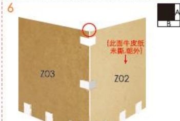
每两块有机玻璃的交接处都需要用F05固定(防止有机玻璃脱落)
