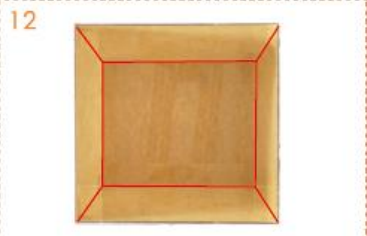
在两块玻璃的接口处涂上适量胶水并稍微用力刮一下使胶水渗透进两块玻璃连接处(画红线的地方为有机玻璃接口)
