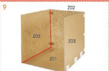
在两块玻璃的接口处涂上适量胶水并稍微用力刮一下使胶水渗透进两块玻璃连接处(画红线的地方为有机玻璃接口)
