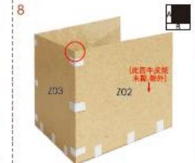
每两块有机玻璃的交接处都需要用L04固定(防止有机玻璃脱落)
