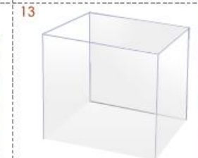
放置1个小时,待胶水干透后,再将有机玻璃外面一层牛皮纸撕掉。
