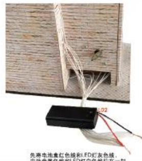
先将电池盒红色线和LED灯灰色线, 电池盒黑色线和LED灯白色线行在一起。
