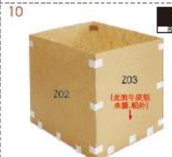
每两块有机玻璃的交接处都需要用L04固定(防止有机玻璃脱落)
